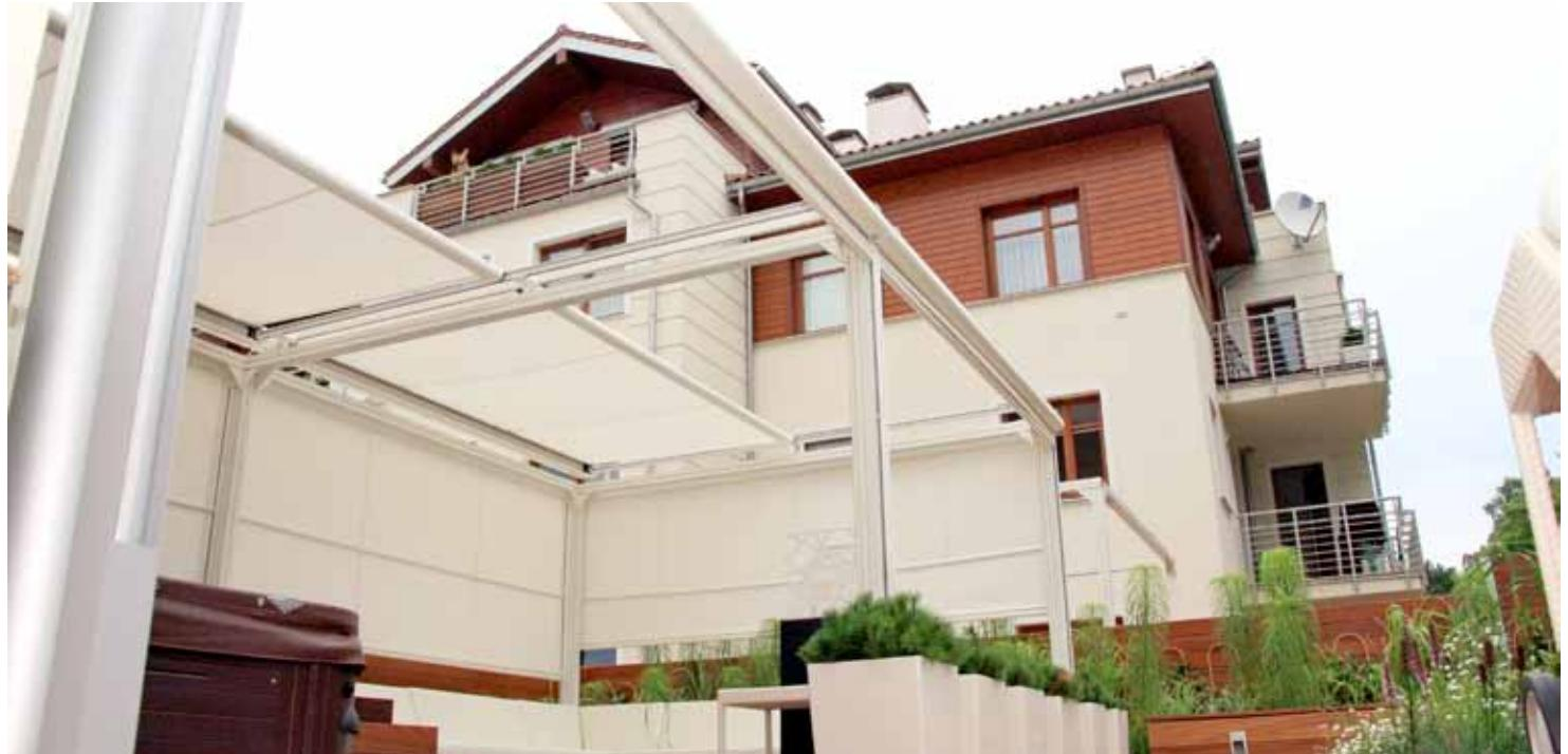
Система Веранда FTS с функцией натяжения полотна применяется для затемнения горизонтальных и наклонных стеклянных поверхностей: зимних садов или окон в виде фонарей. Два электропривода, со встроенными датчиками перегрузки, обеспечивают оптимальное натяжение полотна даже при больших размерах конструкции. Использование этой модели доступно как снаружи помещения, так и внутри.
