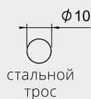
Боковые направляющие в виде троса из нержавеющей стали диаметром 10мм, выполняют одновременно функцию несущего элемента конструкции кассеты. Трос крепится к фасаду здания при помощи алюминиевых кронштейнов и кислотостойких зажимов из стали.
