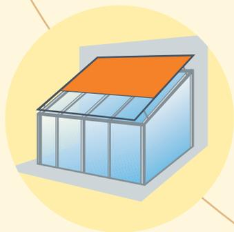
Здесь поможет навес смонтированный над крышей, который в комплексе с хорошей циркуляцией воздуха и вентиляцией значительно снижает аккумуляцию теплого воздуха. Так с помощью такой солнечной защиты уменьшается воздействие солнечного тепла до 5%. Без каких либо солнцезащитных средств 60% солнечной энергии проникает через стандартное тепло-защитающее стекло.
