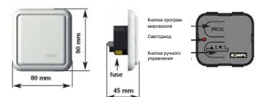
1810165 Артикулярный номер: 220-240V~50/60 Hz Напряжение питания: Предохранитель: 3,15 A Степень защиты корпуса: **IP30** Класс защиты: Нагрузка: лампы накаливания или галогенные, максимальной мощностью 500Bm
